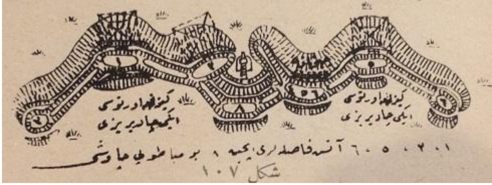
Şekil 2.107. Sürünme hendekleri ile bağlanan avcı çukurları
