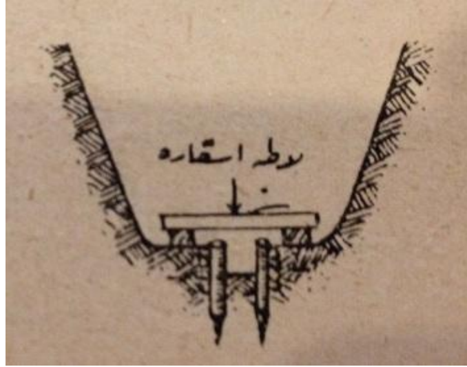
Şekil 2.128. Pek Sağlam Olmayan Toprakta İksa Edilmiş Oluk
