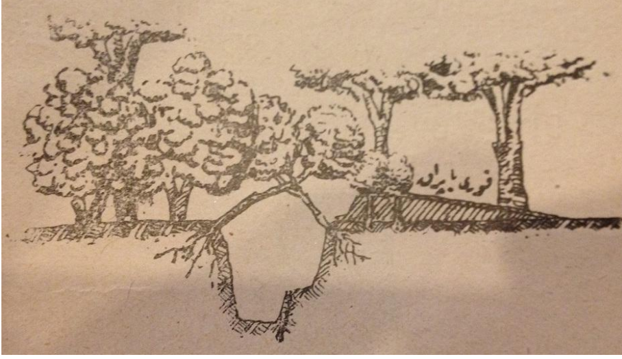
Şekil 2.12. Yapraklı orman dâhilindeki ağaçlar altında gizlenmiş bir avcı yuvası. Gizleme için istifade edilen fidanlar gölgelerinden çıkarılmayarak bırakılmıştır. Aksi halde yaprakları çabuk kuruyacaklarından mevzi’i çabuk belli eder. Çam ormanlarında tehlike daha azdır.
