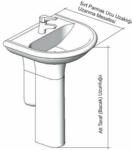
Şekil 16. Lavabo Tasarımında Kullanılması İçin Önerilen Bazı Antropometrik Ölçüler ( http://proje.dizini.net/resimler/sink_91931.jpg )
