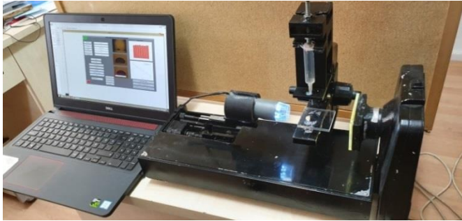
Şekil 5. Temas açısı ölçüm sistemi
