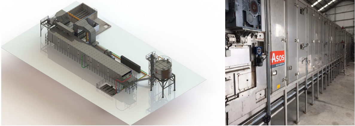
Şekil 6. Örnek Bant Kurutucu Tesisi [8].
