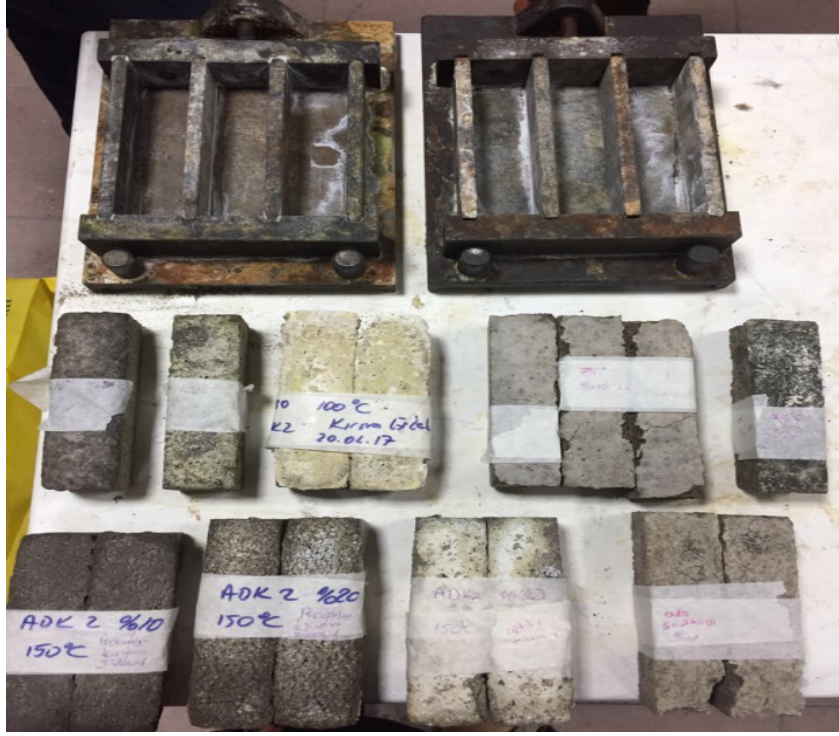
Fotoğraf 1. ADK'dan üretilen geopolimer yapı malzemesi örnekleri
