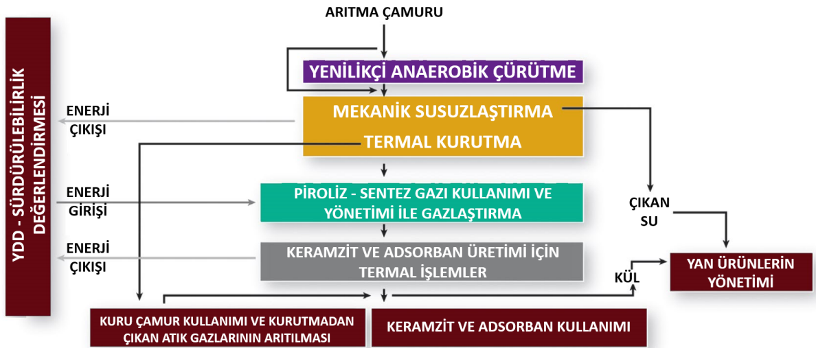
Şekil 3. Enerji girişi-çıkışı bir fonksiyonu olarak arıtma çamuru yönetiminin olası yolu [55].
