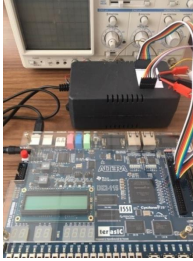
Şekil 12. Altera DE2-115 FPGA geliştirme kartı deneysel çalışması.
