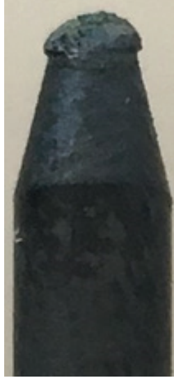
Şekil 17. Kısa devre nedeniyle bozulan elektrot ucu
