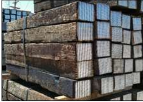
Şekil 10. Ahşap traverse sac plaka takviyesi
