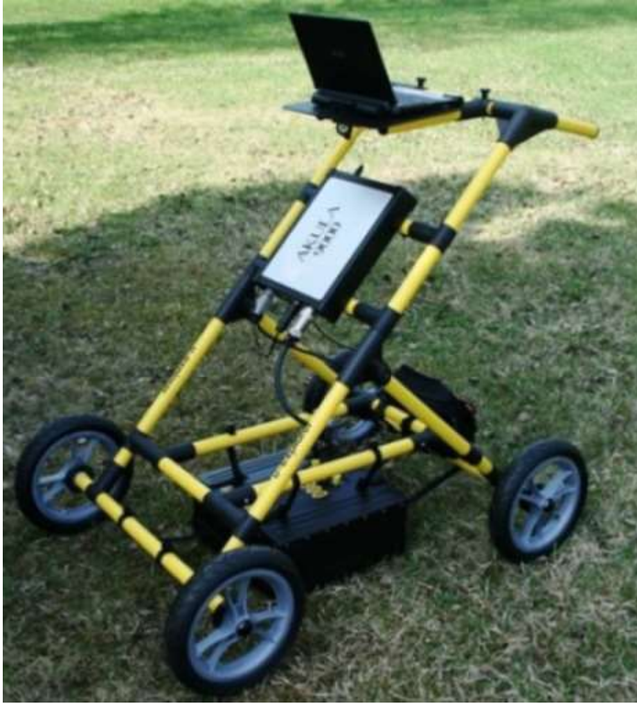
Şekil 3. Çalışmada kullanılan "Geoscanners AB" marka "U-Explorer System" Geo-radar
