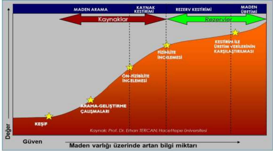
Şekil 2. Maden varlığı bilgi düzeyi ile proje aşamaları (Tercan, 2015)
