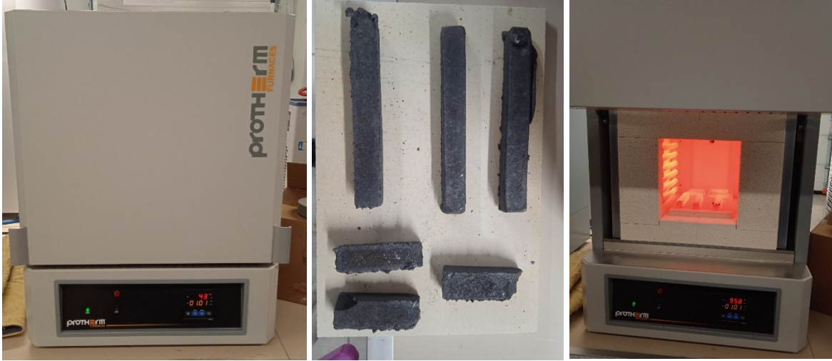
Şekil 2. Protherm marka ısıtma fırınına yerleştirilmiş numuneler ve östenitik yapıya geldikten sonraki görüntü
