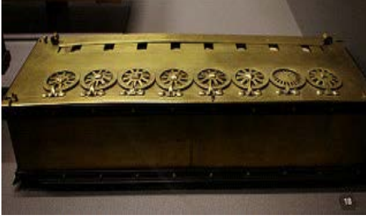
Şekil 3: Blaise Pascal'ın hesap makinesinin bir resmi ( The Pascaline)
