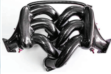
Şekil 2. PP Emme manifoldu (Gail et al,2013) Şekil 3. Karbon elyaftan üretilmiş manifold (JGR Products) (Keegan, 1998; Çetin vd, 2019; Sambale, 2009; www.ptonline.com,2012).
