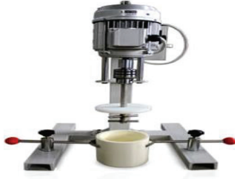
Şekil 4. Deney için dikey bulamaç değirmeni
