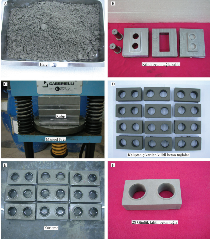
Şekil 7. Kilitli beton tuğla üretim aşamaları. (A) granit çamuru, çimento ve su ile hazırlanmış harç (B) Tasarlanan çok parçalı kalıp (C) manuel kontrollü pres (D) Sıkıştırılmış ve kalıptan çıkarılmış taze kilitli beton tuğlalar (E) Kürleme işlemi, (F) 28 günlük kilitli beton tuğlalar.
