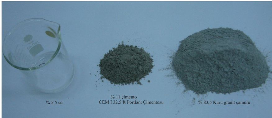
Şekil 6. Kilitli beton tuğla üretiminde kullanılan malzemeler ve karışım oranları.
