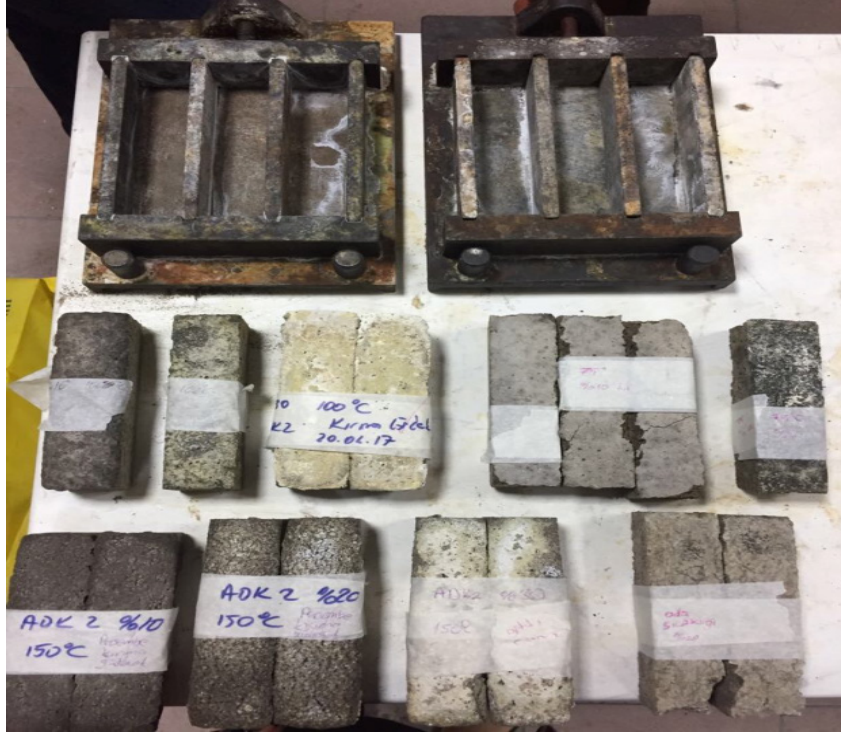
Fotoğraf 1. ADK'dan üretilen geopolimer yapı malzemesi örnekleri
