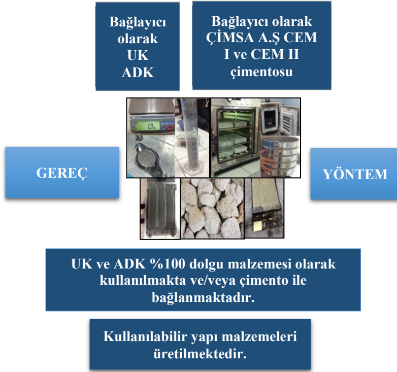
Şekil 1. UK ve ADK'dan yapı malzemesi üretim çalışmalarının temel akım şeması
