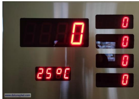
Şekil 2.2.10. Erişilebilir tuvalet ve çağrı izleme ünitesi.
