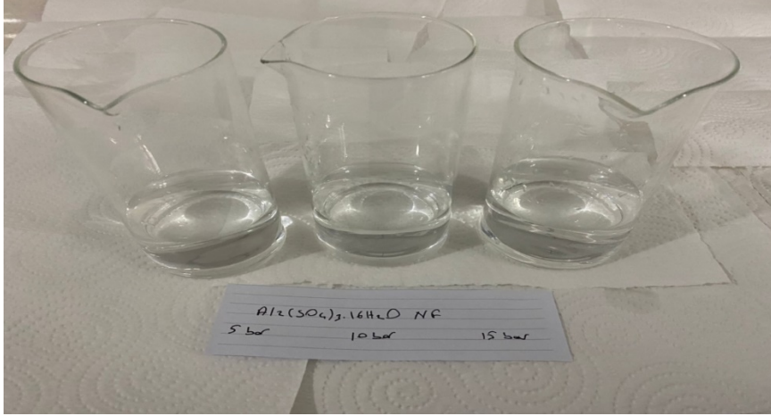
Şekil 3.2 Koagülasyon-flokülasyon ile arıtılmış stok atık suyun çapraz akışlı NF membran prosesinde ileri arıtılması sonucu çıkış suyunun görüntüsü
