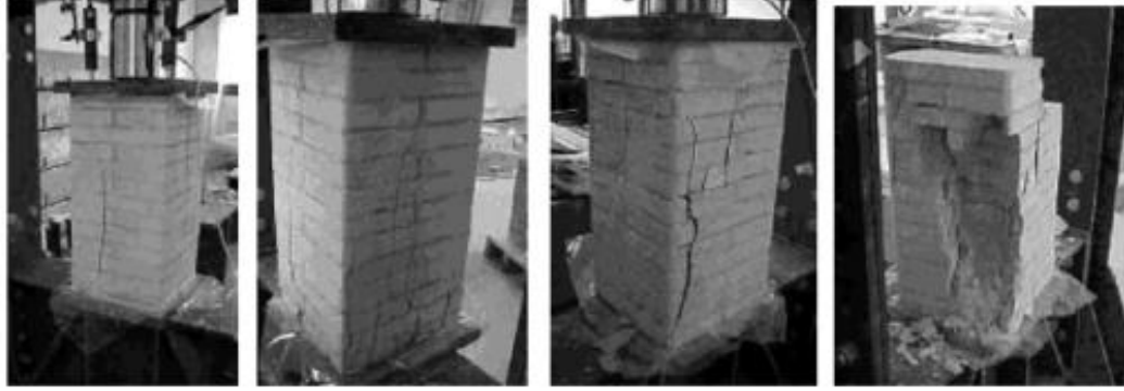
a) Güçlendirilmemiş sütunun deney sonrası
