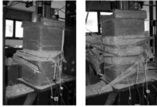
b) Güçlendirilmiş sütunun deney sonrası görüntüsü
