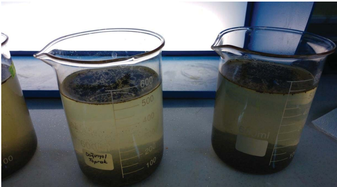
Şekil 3.1 Koagülasyon-flokülasyon ile arıtımda yapılan çalışmanın görseli
