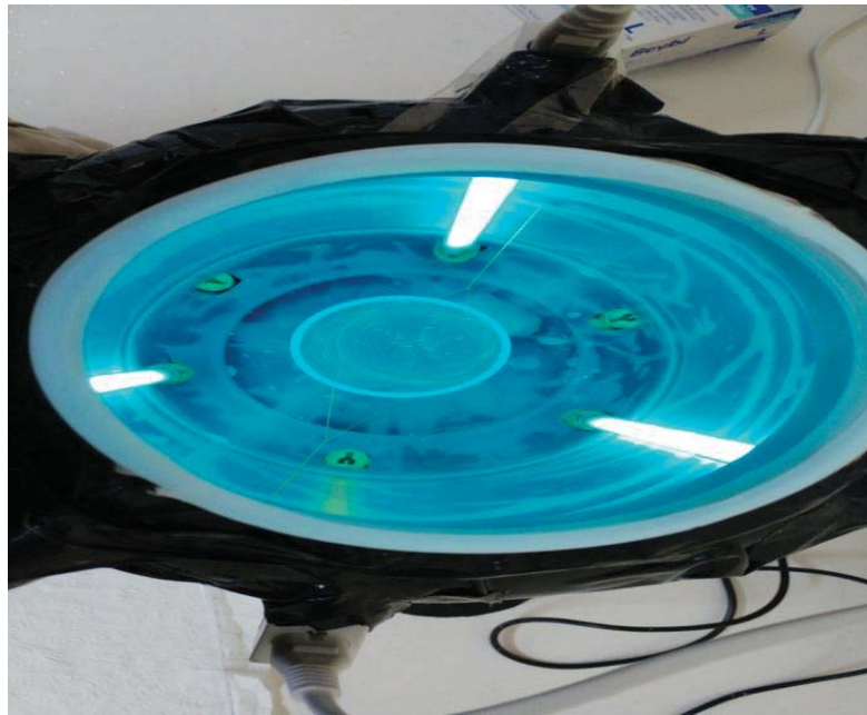
Şekil 3.2 Deneylerde kullanılan fotoreaktörün üstten görünümü
