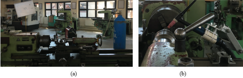
Şekil 8. TIG esaslı ısı destekli işleme deney düzeneği (a), torç tutucu aparat (b)
