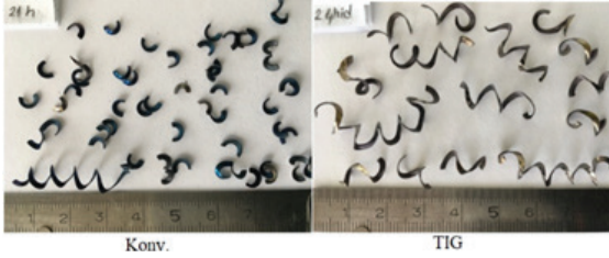
Şekil 14. Talaş oluşumları ( V=305 m/dak, f=0,24 mm/dev)
