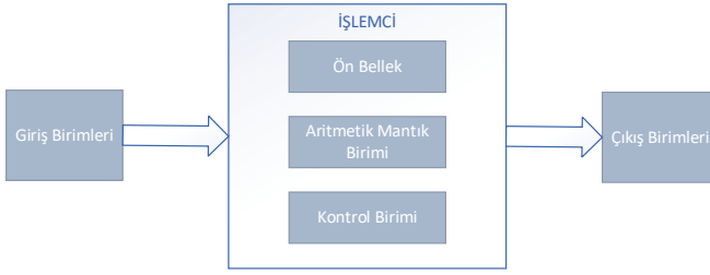
Şekil 3. Aritmetik Mantık Ünitesi mimarisi blok diyagramı.
