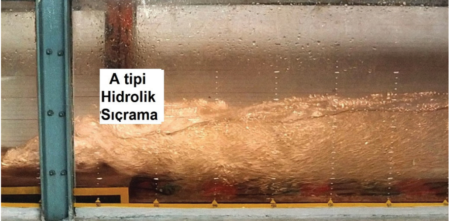
Şekil 4. Ani Taban Düşülerinde A Tipi Hidrolik Sıçrama
