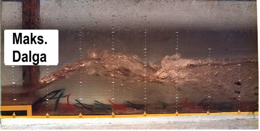
Şekil 6. Ani Taban Düşülerindeki Dalga Tipi Akım (Maksimum Dalga)
