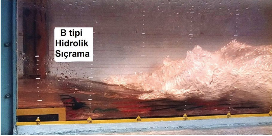
Şekil 5. Ani Taban Düşülerinde B Tipi Hidrolik Sıçrama
