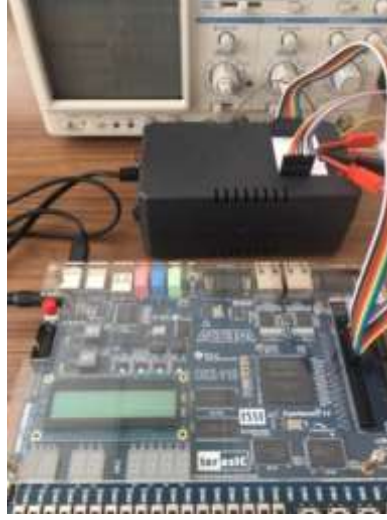
Şekil 12. Altera DE2-115 FPGA geliştirme kartı deneysel çalışması.
