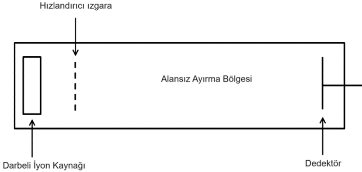
Şekil 21. Uçuş Süresi (TOF) analizörünün şematik gösterimi (Haag, 2016)
