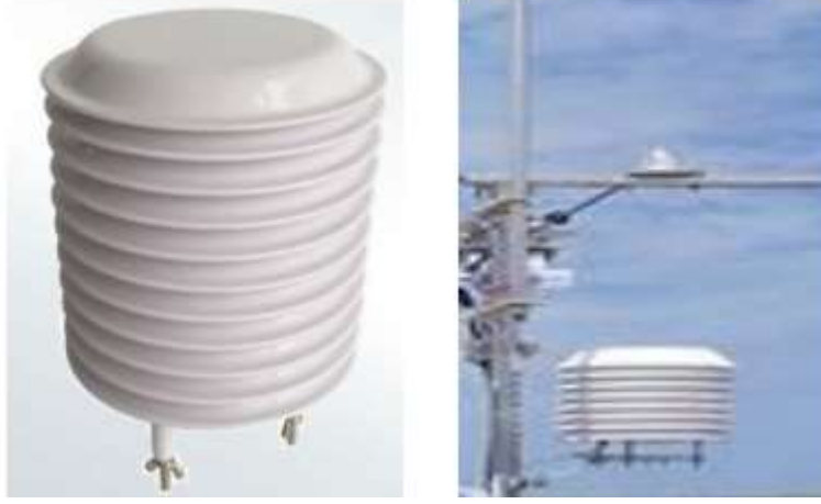
Şekil 8. Ölçüm istasyonunda kullanılan sıcaklık ölçer.
