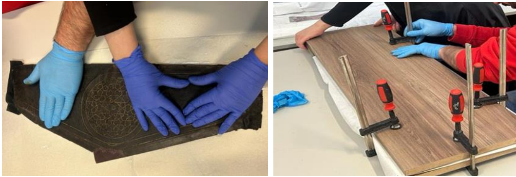
Resim 39-40. Yapıŝtırma iŝlemi tamamlanan derinin pres altına koyulması
