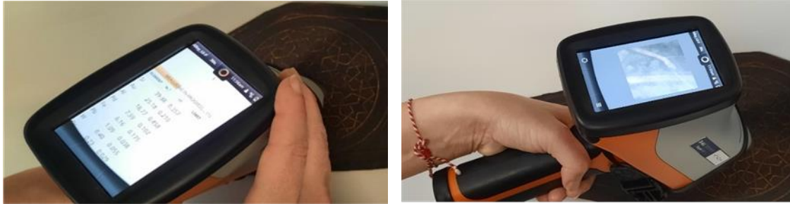
Resim 13-14. XRF ile deri yüzeyde ölçüm yapılması
