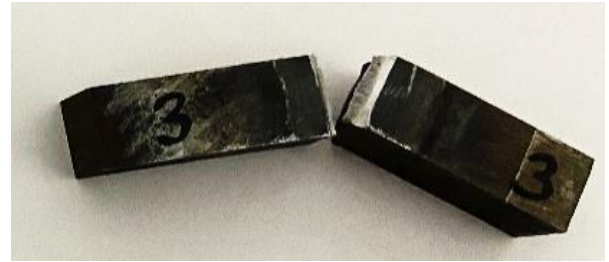
Şekil 2 S3 numunesinin çentik darbe testi sonrası kırık yüzey makro görüntüsü
