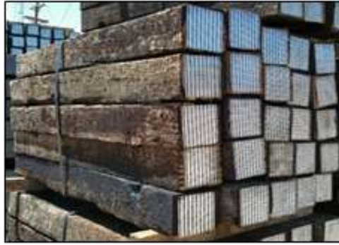
Şekil 10. Ahşap traverse sac plaka takviyesi
