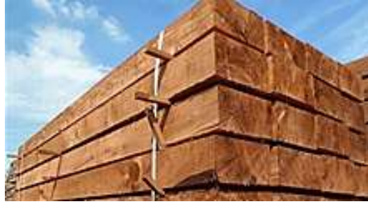
Şekil 1. Ham traverslerin açık havada bırakılması
