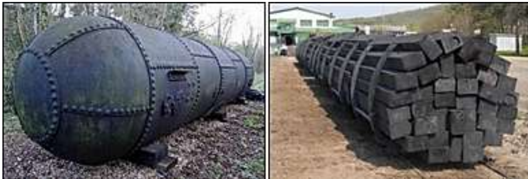
Şekil 4. a) Enjekte işlemi makinesi ve b) enjekte işlemi yapılan traversler
