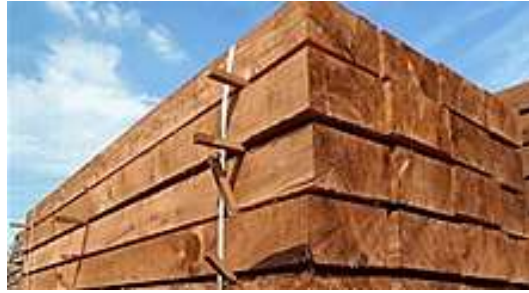
Şekil 1. Ham traverslerin açık havada bırakılması
