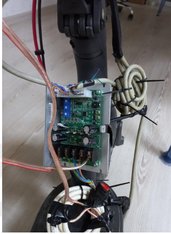
Şekil 5.8 Motor sürücüsünün EKS montajı
