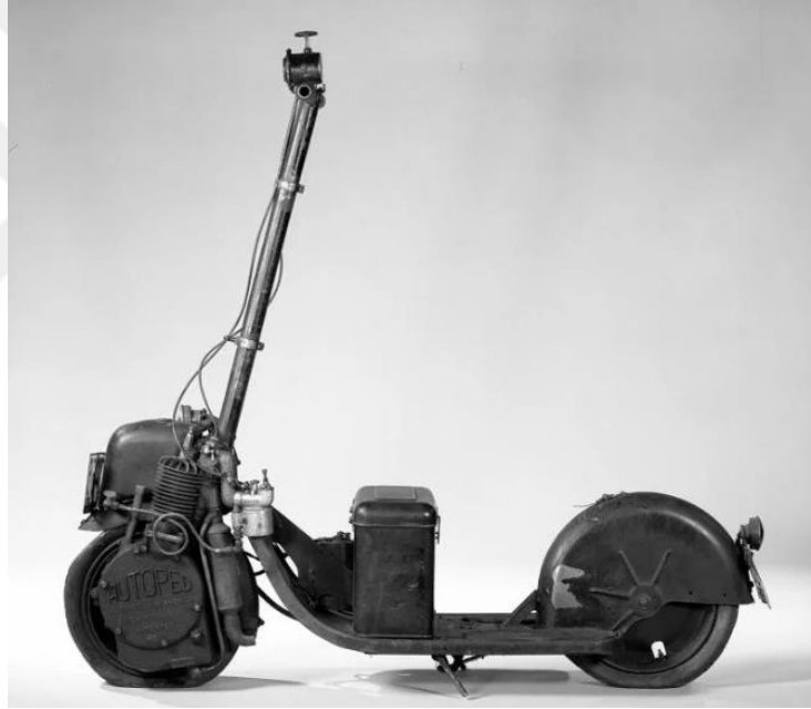
Şekil 1.6 1918 den kalma içten yanmalı motora sahip bir scooter Ulusal Amerikan tarihi müzesi ( The Motorized Scooter Boom That Hit a Century Before Dockless Scooters | History| Smithsonian Magazine )
