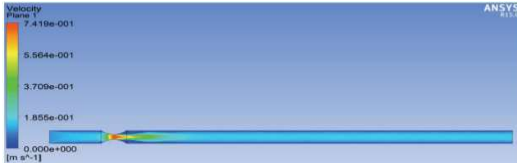
Şekil 2: Referans alınan makalede [14] %60 daralma olan tıkanık damar için akış hızı analizi
